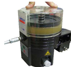
Llenado del depósito Fig. 19
