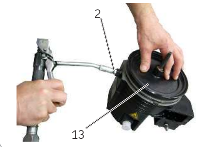
Llenar el espacio por debajo del depósito Fig. 16
